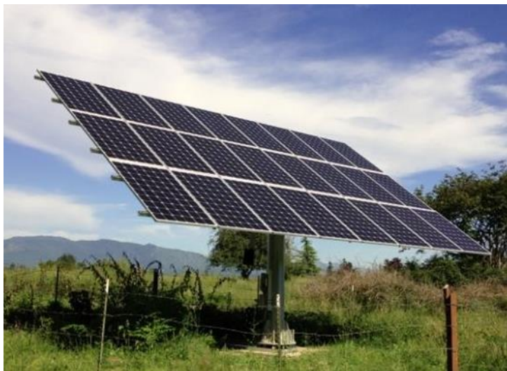
Рисунок 1.11 – Двоосьовий механізм просторового орієнтування на центральній опорі (TTDAT)
