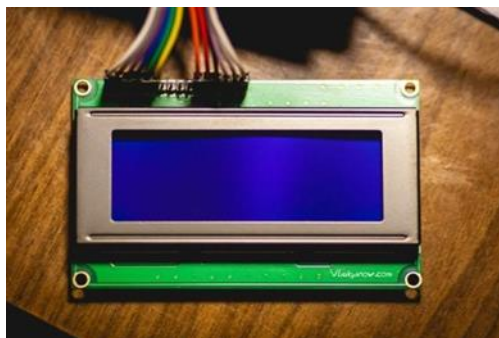
Рисунок 3.3 – Зовнішній вигляд символьного рідкокристалічного індикатора формату 20x4
