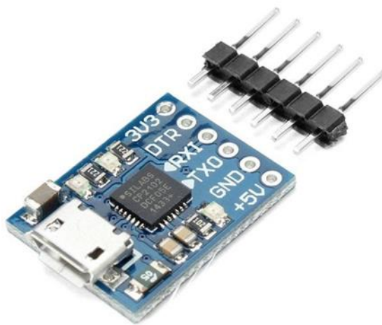
Рисунок 3.4 – Зовнішній вигляд модуля апаратного конвертера USB-UART на базі мікросхеми CP2102
