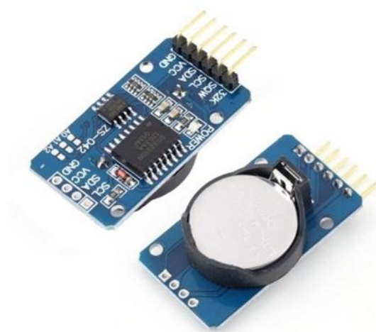
Рисунок 3.7 – Апаратний модуль прецизійного годинника реального часу на базі інтегральної мікросхеми DS3231
