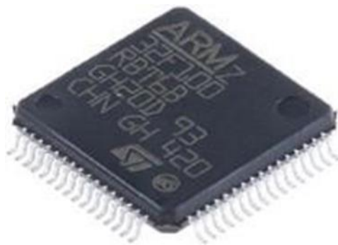
Рисунок 3.1 – Зовнішній вигляд та форм-фактор мікроконтролера STM32F100C4T6B
