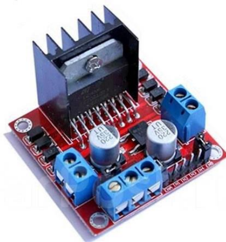
Рисунок 3.10 – Силовий модуль драйвера електродвигунів RKP-01A на базі чипа L298N
