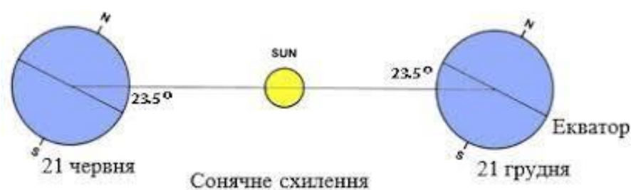
Рисунок 1.5 – Геометрична інтерпретація кута сонячного схилення
