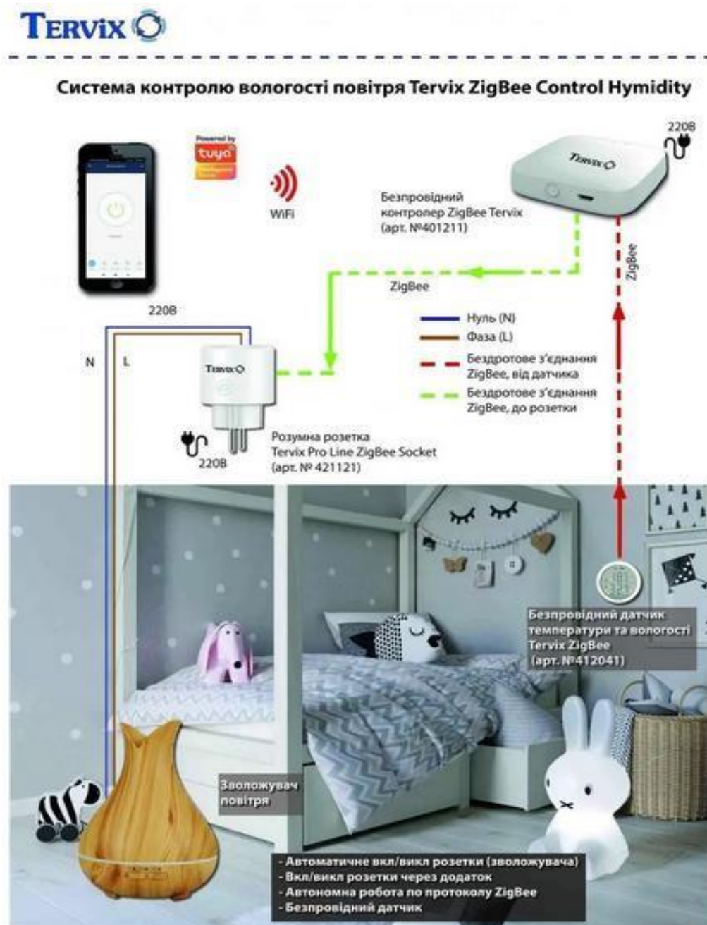
Рисунок 1.5 – Апаратний комплекс інтелектуального моніторингу та регулювання мікроклімату в концепції Smart Home
