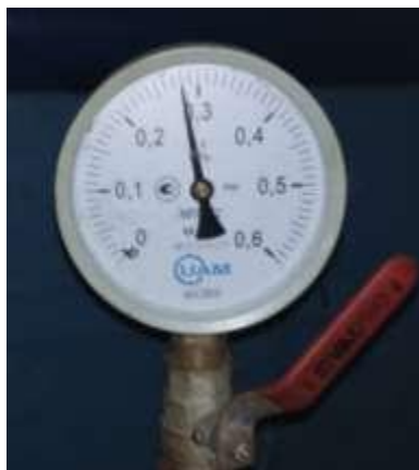
Рисунок 3.13 – Стрілочний манометр для візуального контролю тиску
