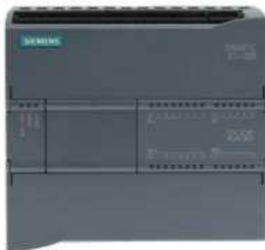
Рисунок 2.6 – Центральний процесорний пристрій Siemens SIMATIC S7-1200 моделі 1214C
