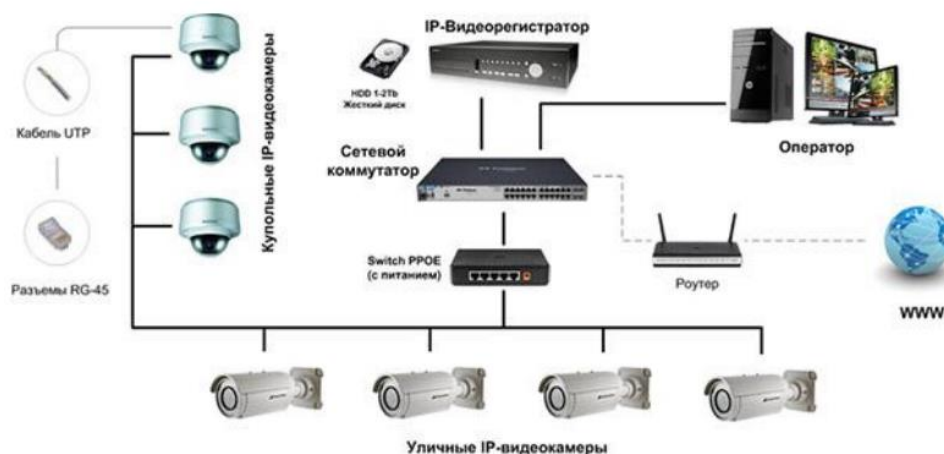
Рисунок 1.4 – Схема системи відеоспостереження
