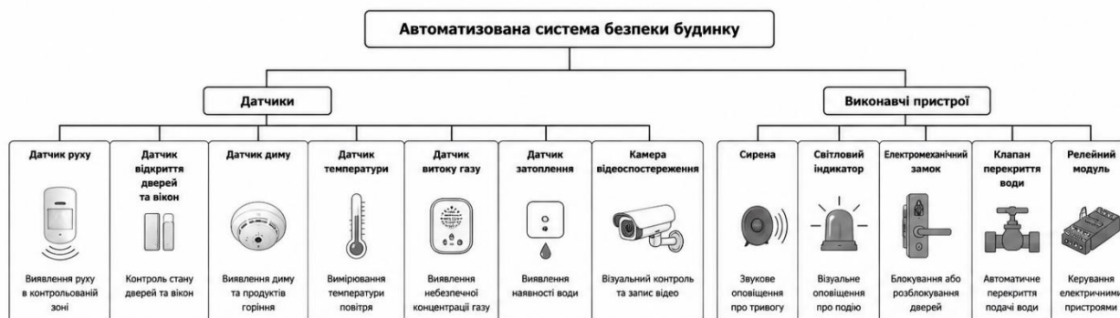
Рисунок 1.10 Класифікація датчиків та виконавчих пристроїв автоматизованої системи безпеки будинку
