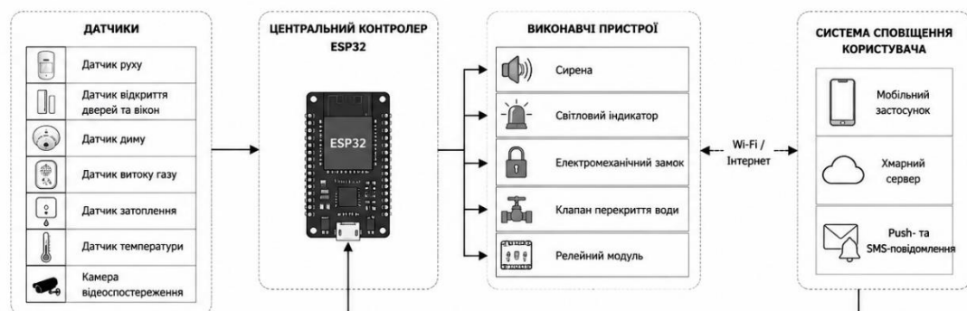
Рисунок 1.11 Структурна схема взаємодії датчиків, контролера та виконавчих пристроїв автоматизованої системи безпеки будинку
