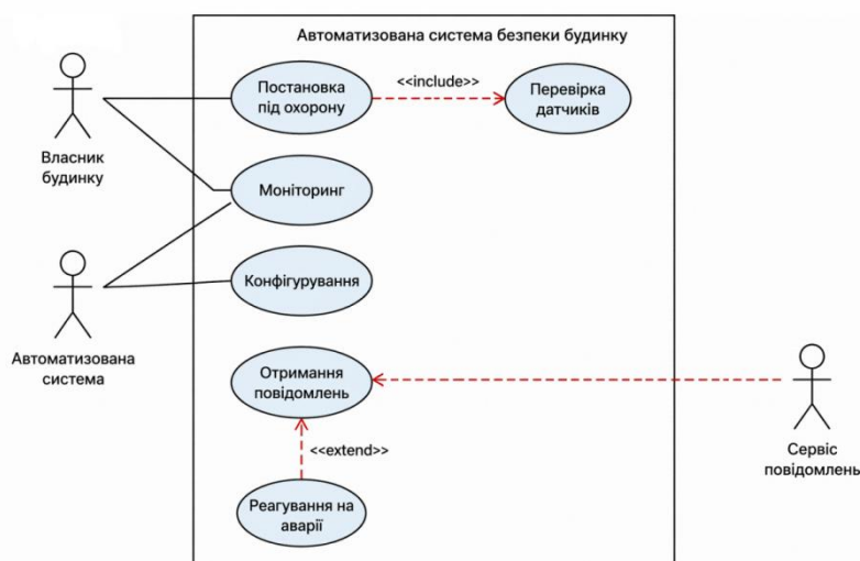
Рисунок 2.2 – UML-діаграма варіантів використання АСУББ
