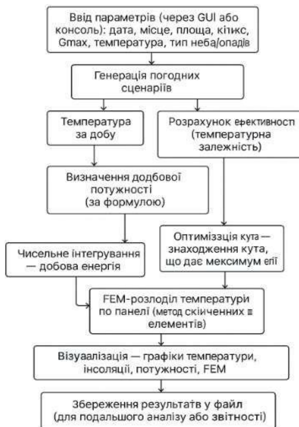
Рисунок 2.4 – Діаграма потоків даних (Data Flow) усередині програмного комплексу
