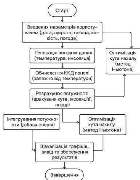
Рисунок 2.3 – Алгоритмічна блок-схема процесу імітаційного моделювання
