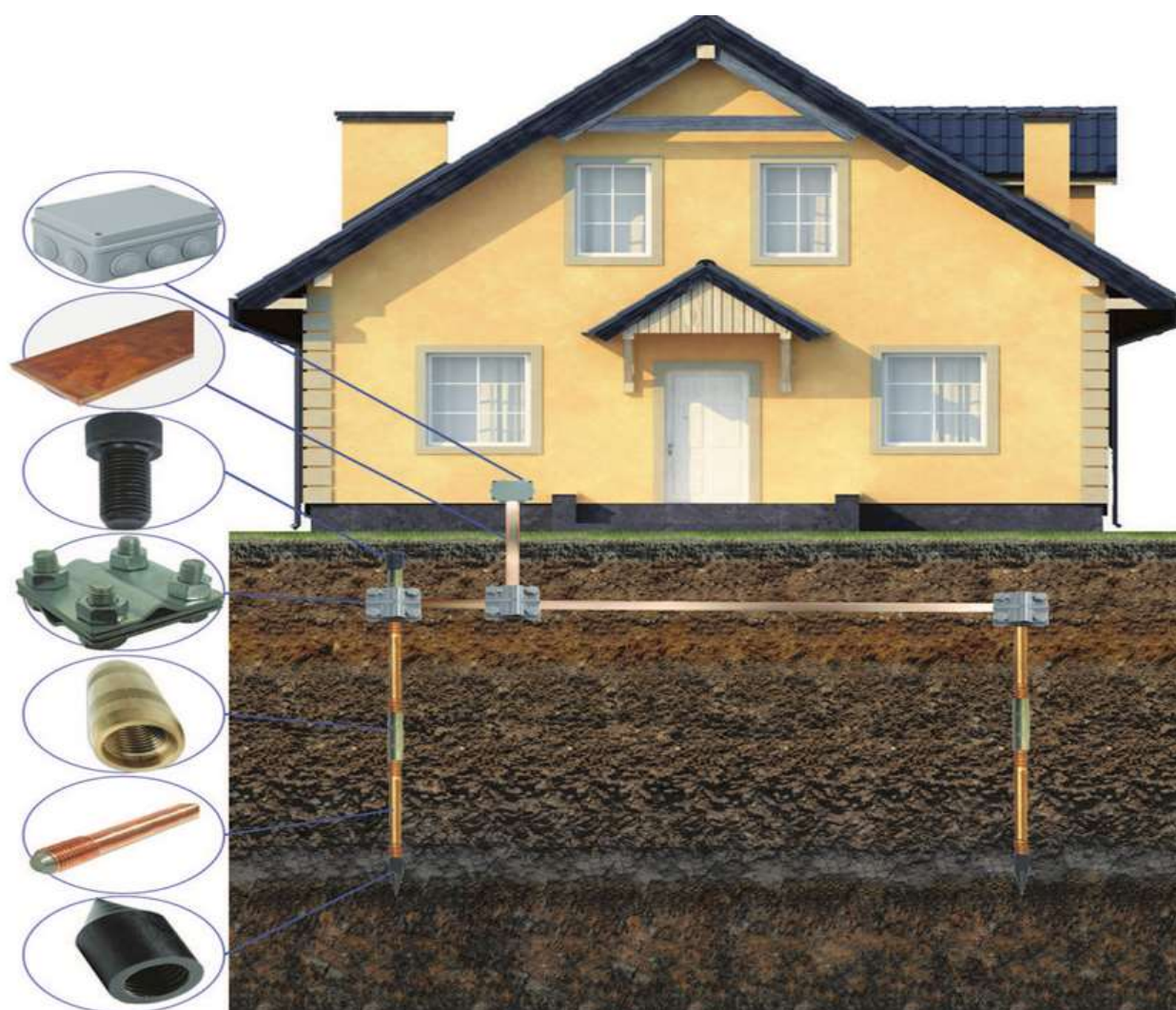
Рис. 3.3 Єдина точка заземлення
