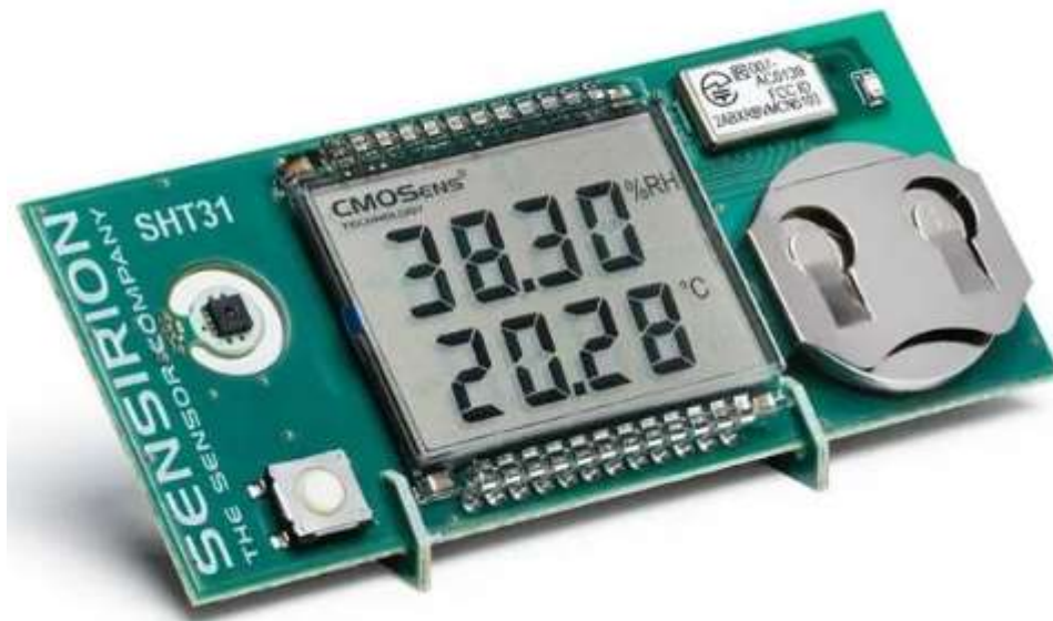
Рис 2.2 Цифровий датчик температури та відносної вологості повітря SHT31
