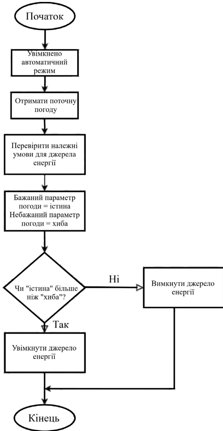
Рис.3.2. Блок-схема алгоритму моніторингу енергопостачання житлового котеджу
