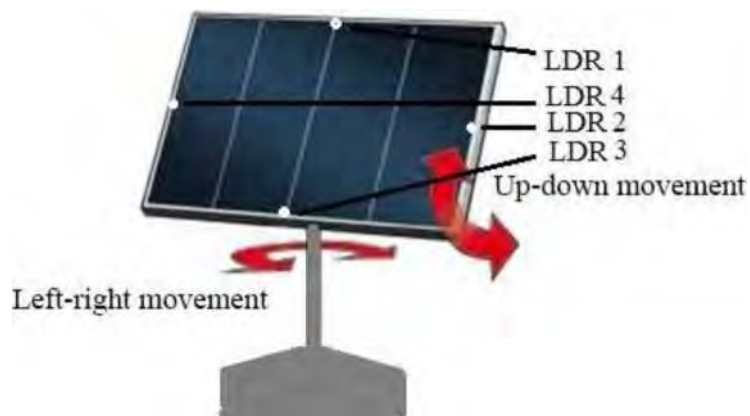
Рис. 3.11. Рух двовісьового трекера
