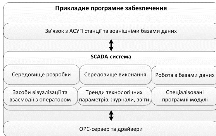
Рис. 3.7 Структура прикладного програмного забезпечення
