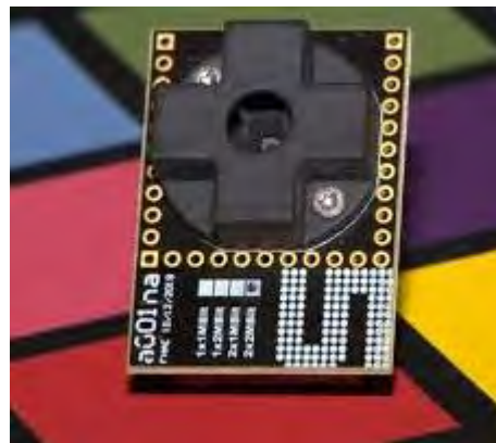
Рис 3.1 Датчик освітленості, кольорової температури та спектрального розподілу світла Vishay VEMML6040.
