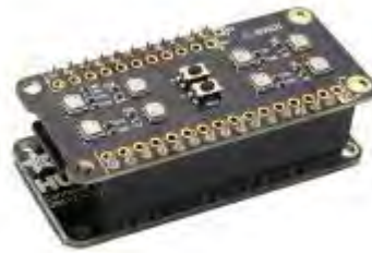
Рис 2.3 Датчик контролю летких органічних речовин Bosch BME688
